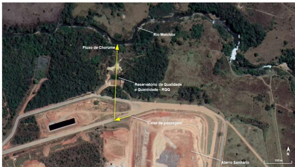
Figura 01: Percurso e direção do fluxo de chorume, marcado com as setas amarelas, do primeiro vazamento. Partindo da caixa de passagem, atravessando o Reservatório de Qualidade e Quantidade e chegando ao Rio Melchior.
